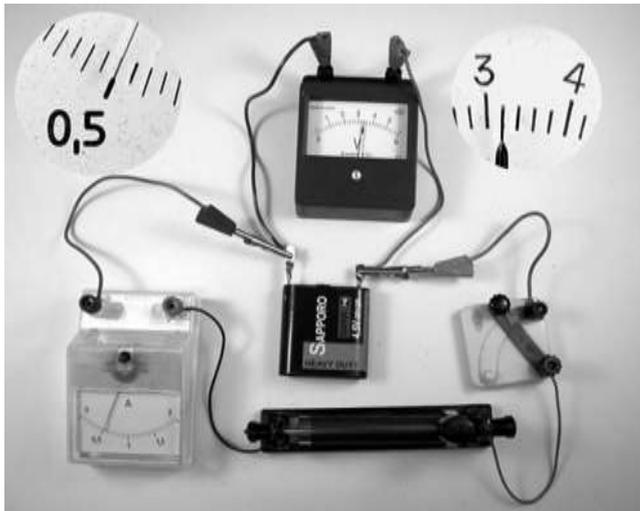
1. На рисунке приведена фотография электрической цепи по измерению сопротивления реостата. Погрешности измерения силы тока в цепи и напряжения на источнике равны половине цены деления амперметра и вольтметра. Какова по результатам этих измерений сила тока, протекающего через источник?
