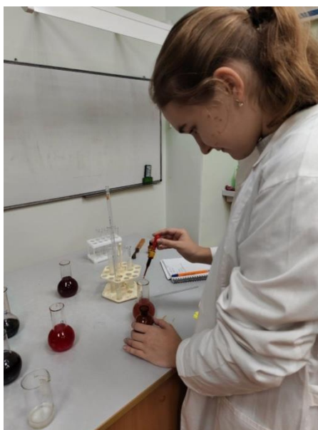
Рис. 4. Добавление крахмального клейстера
